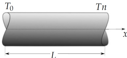
Slika 5.9: Šipka čiji su krajevi u kontaktu sa termostatima na konstantnim temperaturama T_0 i T_n
