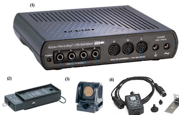
Slika 1.4 Osnovne komponente aparature se dve prethodne slike. (1) – sistem za prikupljanje (akviziciju) podataka; (2) – senzor sile; (3) – senzor pozicije; (4) – senzor ubrzanja.
